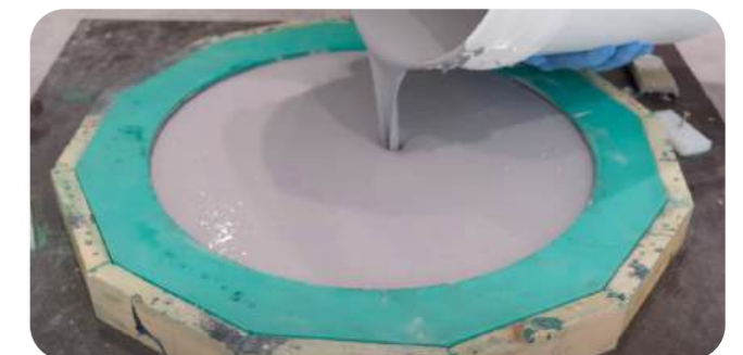
Step Six Pour remaining mixture into mould.
