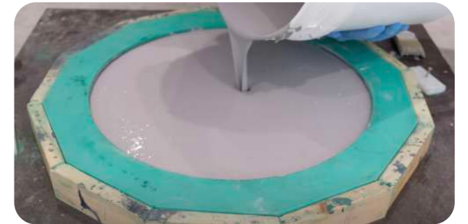
Step Six Pour remaining mixture into mould.
